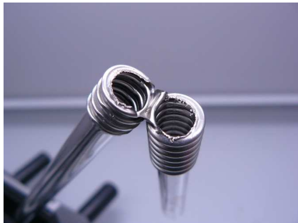
Bild / Figure 16: 2 Sekunden mit 40 °C warmen Wasser durchspülen / Rinse with 40 °C warm water for 2 seconds
